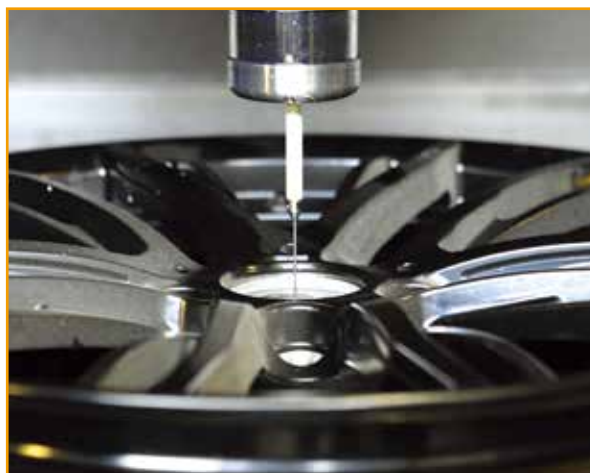
RMP60正在测量合金轮圈的安装面
