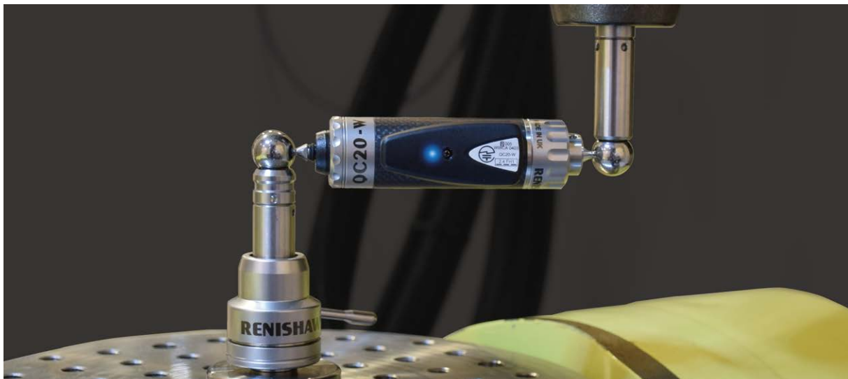
테스트를 수행하고 있는 Renishaw QC20-W 볼바 시스템
