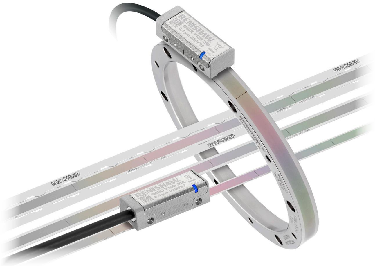
Die QUANTiC™ Messsystembaureihe ermöglicht robuste inkrementelle Positionsmessungen für lineare, teilrotative und rotative Systeme mit hohen Installationstoleranzen. Die sonst während des Installationsvorgangs erforderlichen Korrekturen werden dadurch reduziert oder entfallen ganz.
