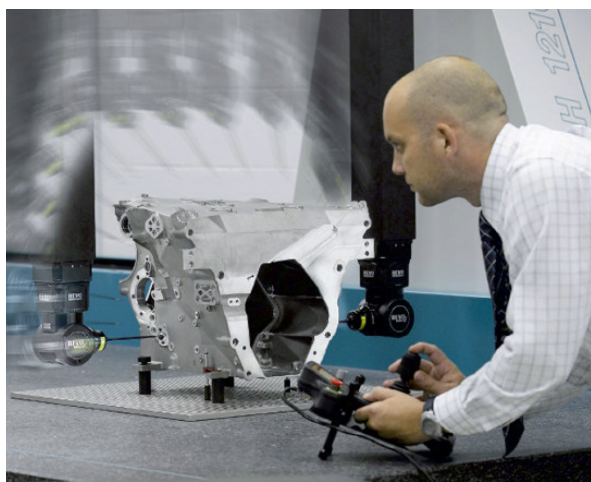
Pětiosé skenování umožňuje velmi rychlou a plynulou rozměrovou kontrolu složitých dílců.
